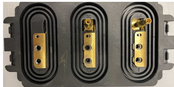
Fig. 1. Wolfspeed 10 kV XHV-9 SiC MOSFET power module.
